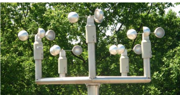
Prüfstand zur Bewertung der Alterung konventioneller Schalenkreuz-Anemometer
